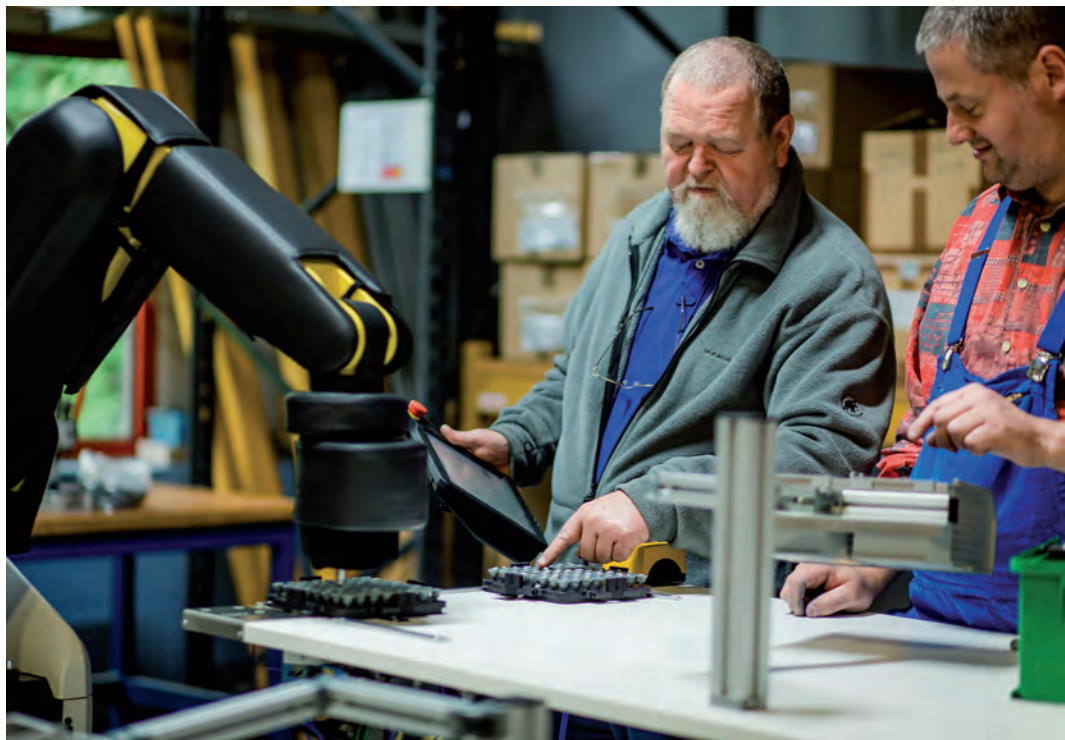
In der Werkhalle der gemeinnützigen ISAK gGmbH ist der erste Mensch-Roboter-Arbeitsplatz entstanden, der speziell für schwerbehinderte Produktionsmitarbeiterinnen und -mitarbeiter in der Düsenmontage entwickelt wurde.
